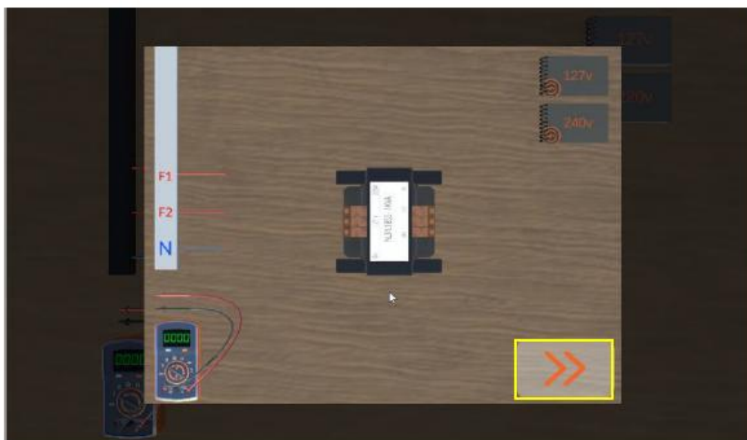
Figura 4 – Configuração dos terminais e medição de tensão no simulador Algetec.
